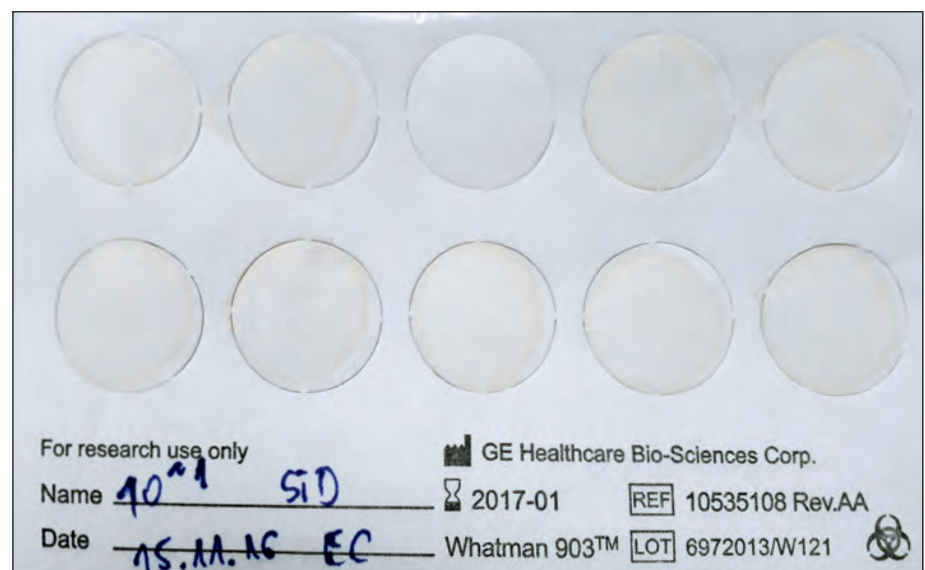
Abb. 1: Dried Serum Spots (DSS). Pro Spot werden etwa 100 µl Serum auf ein Filterpapier getropft. Aus den Spots werden Antikörper und virale RNA für weitere Analysen eluiert.
